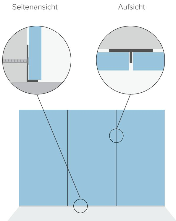
1. Montieren Sie das L-Profil entlang der Wandunterseite horizontal waagrecht an der Wand
